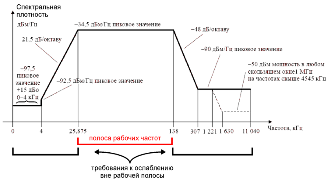
Рис. 17. Спектральная маска передатчика абонента ADSL и ADSL2.
